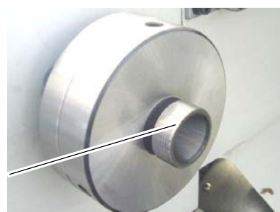
Abb. 3-5: Spannzangenfutter 344 1305 ohne Überwurfmutter dargestellt.
